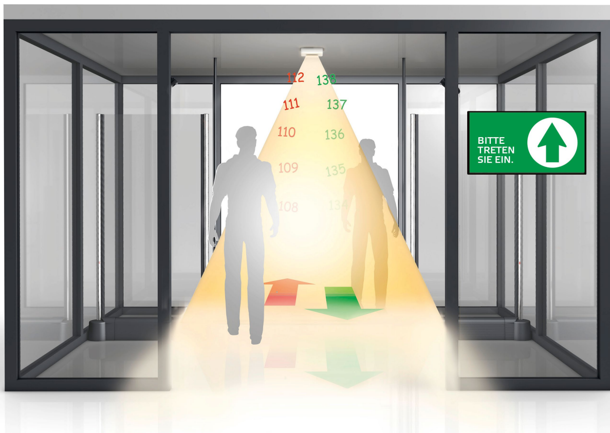
Der 3D-Personenzähler erkennt Kopfform und Schulterpartie und löst darüber einen Zählimpuls aus. Quelle: Wanzl GmbH & Co. KGaA
