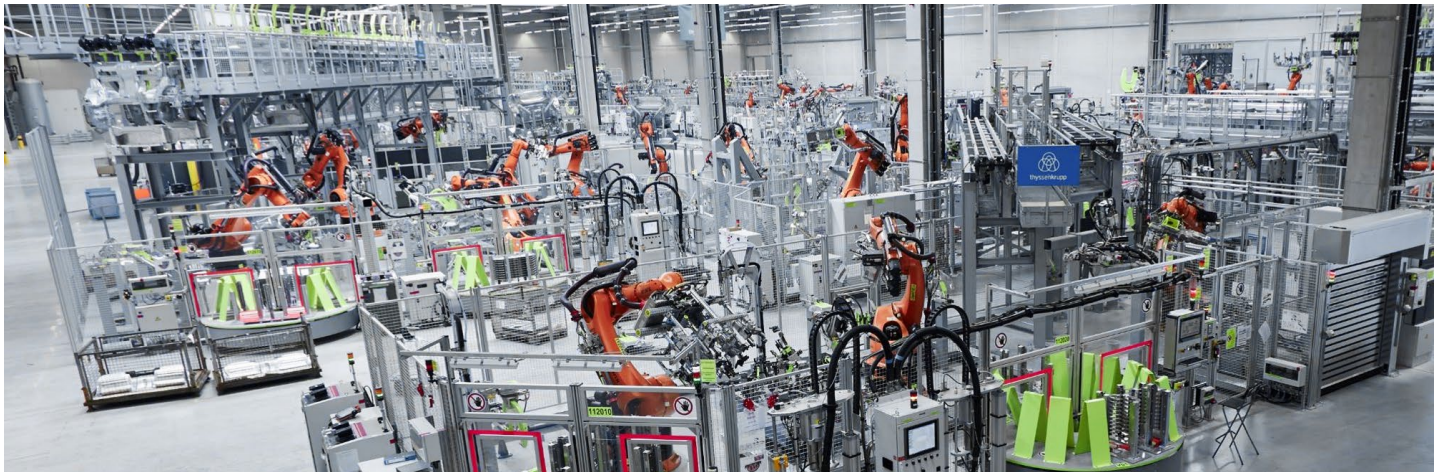
Etwa 250 Roboter fertigen im Werk in Mühlacker Karosserien für Elektroautos.
