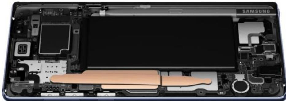
三星 Galaxy Note9 採用熱導管或稱為「散熱片」來提升系統效能，相較於 Galaxy Note8 的散熱片大出 3 倍，能發揮更有效率的散熱作用。此外，Galaxy Note9 亦加大吸液芯的尺寸，以達到更出色的吸熱表現，並採用強化的碳纖維 TIM(熱介面材料)，能以 3.5 倍的效能將處理器產生的熱能轉移到散熱片，大幅提升導熱性能。
