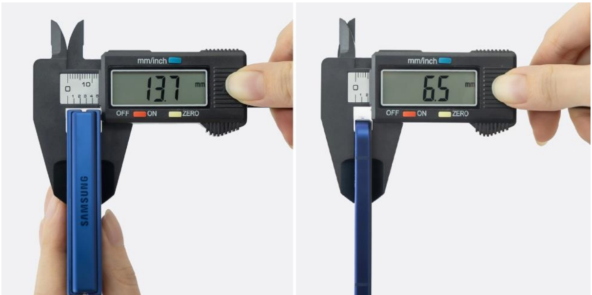
▲ Galaxy Z Flip7 機身採用輕薄化設計，摺疊厚度僅 13.7 mm，展開厚度僅 6.5 mm
