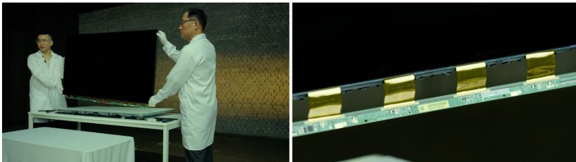
▲液晶層與彩色濾光片控制。裝設在此模組底部的電路板有助於像素級控光，進而建立影像。
