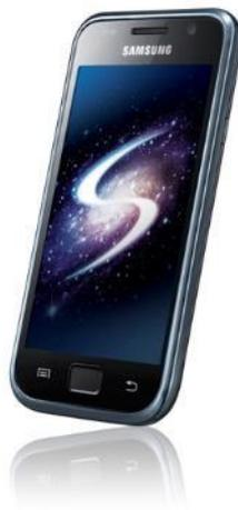
智慧型手機的最大優點，在於其能使用戶透過掌上型裝置，以大螢幕和清晰畫質觀看內容。三星電子率先將 AMOLED 螢幕導入智慧型手機，為智慧型手機產業揭開新紀元，使大螢幕成為市場主流。該顯示螢幕開發採用主動式矩陣有機發光二極體（AMOLED）技術，其特色包括畫質清晰、自體發光，及更大的螢幕尺寸。
