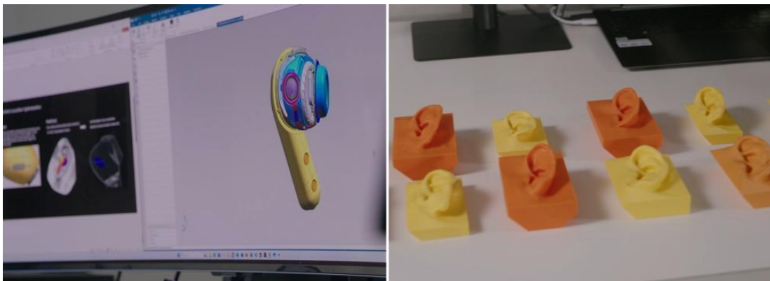
▲ 透過 AI 與基於物理學的模擬推導出最佳化設計參數，接著利用機器測試進行交叉驗證。
