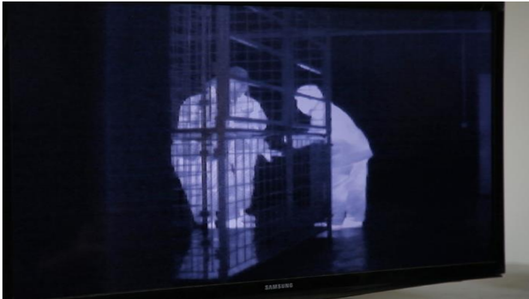
圖為取自第一次實地測試的紅外線影像，類似消防員透過 IGNIS 而能看到的影像
