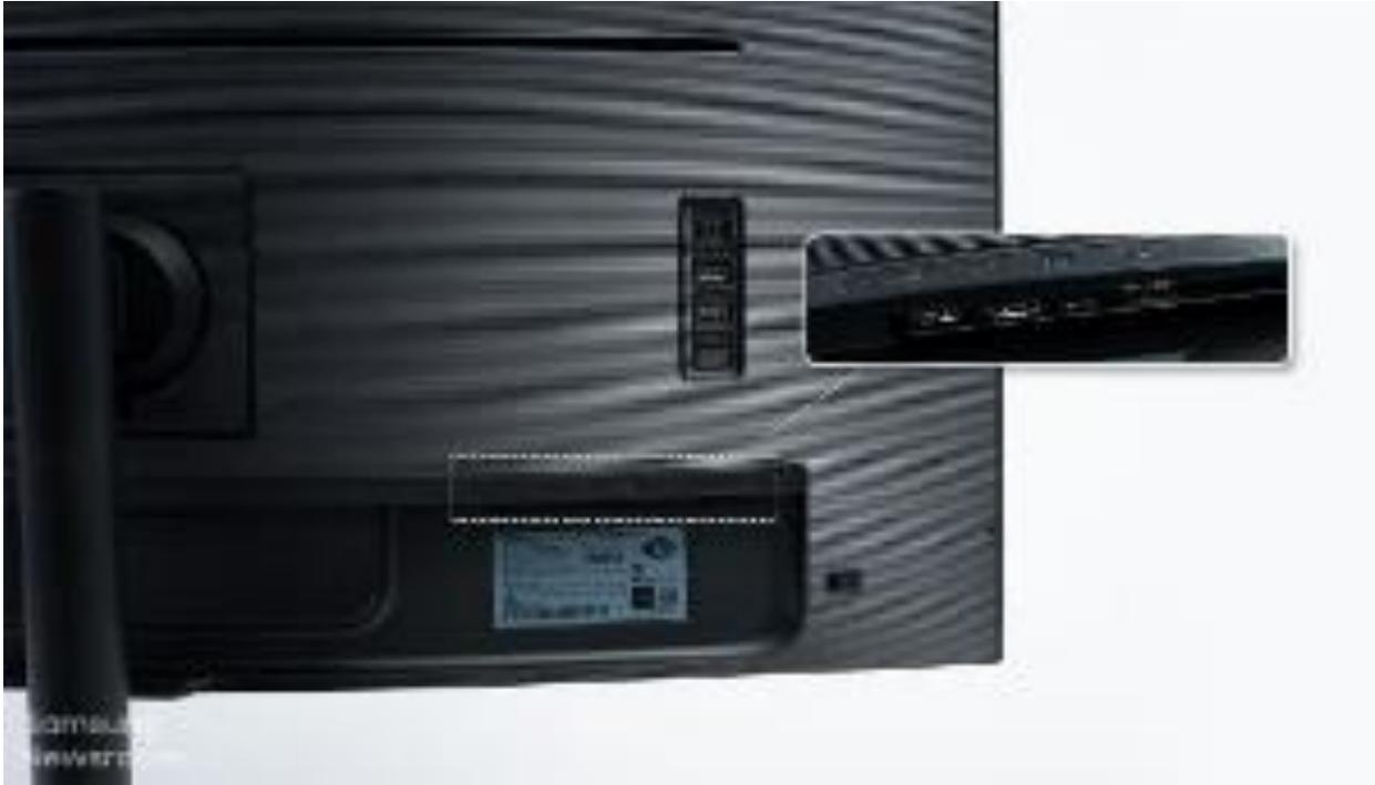
▲ S65UA 顯示器後方凹槽處，共有 4 個額外連接埠（HDMI、DP、Type-C 與 LAN）。
