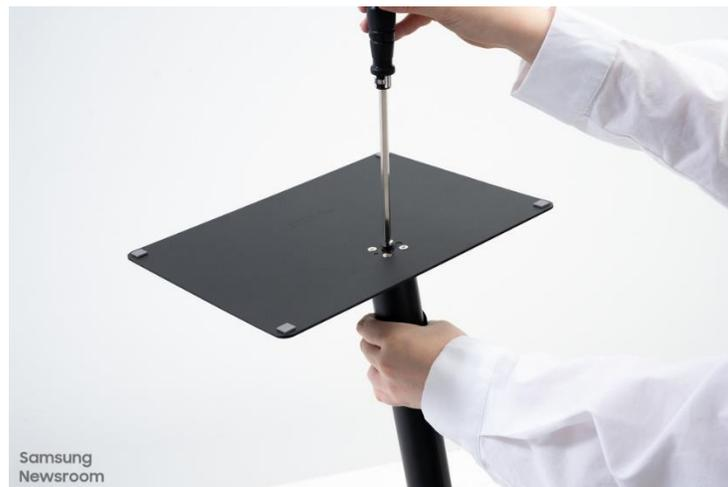
顯示器安裝大致可分為兩個步驟。首先，將矩形支架底座放置於長形支架頸座上，並將支架底座底部的連接螺絲拴緊。安裝螢幕本體時，僅需拴緊中間的大螺絲。接著，將組裝完成的支架底座與頸座卡進顯示器後方，便大功告成。輕輕向上推，聽見「喀噠」一聲，即表示組裝完成<sup>(註一)</sup>。
