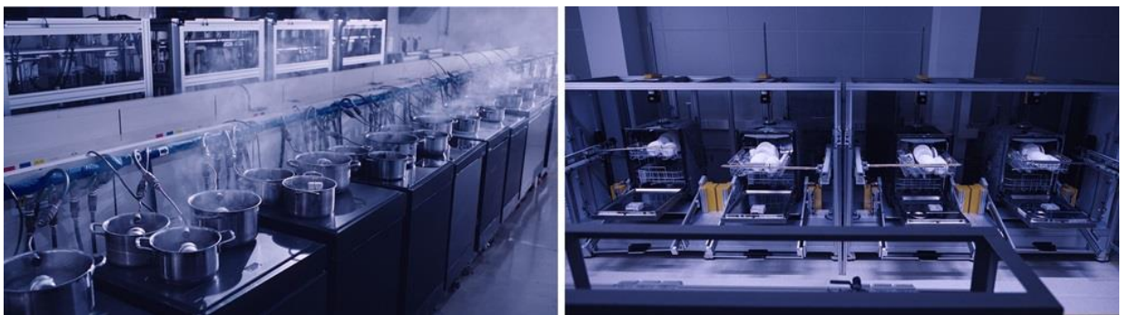
▲ 耐久性測試（左）和籃架抽拉測試（右）
