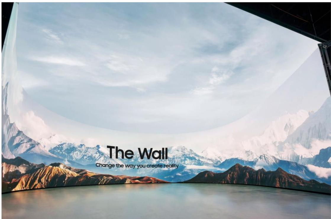
The Wall 顯示器主打客製化規格，能依據內容創作者的需求和不同空間量身規劃，並能安裝於凸面、凹面天花板等環境。其清晰銳利的色彩、HDR10 與 HDR10+ 技術、劇院級 LED 畫質與細節等優勢，使視覺效果更上一層。畫面更新頻率也因應片場需求，支援 23.976、29.97 和 59.94Hz，以確保影像同步、順暢無縫，造就超越以往的製片體驗。
